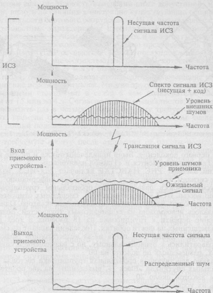
Рис. 4. Сигналы, излучаемые ИСЗ, и их обработка в приемной станции пользователя
